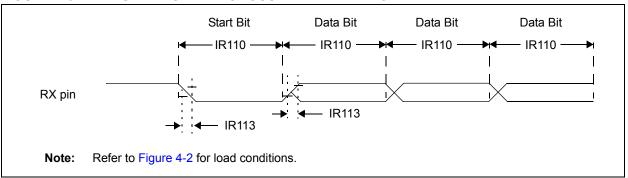
TABLE 4-6: UART ASYNCHRONOUS RECEIVE REQUIREMENTS
