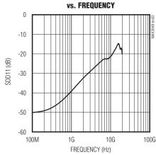
**INPUT COMMON-MODE RETURN LOSS** vs. FREQUENCY
