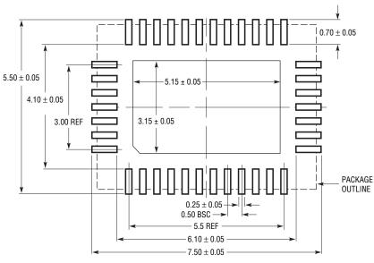
RECOMMENDED SOLDER PAD LAYOUT APPLY SOLDER MASK TO AREAS THAT ARE NOT SOLDERED
