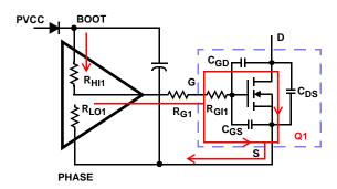
FIGURE 3. TYPICAL UPPER-GATE DRIVE TURN-ON PATH
