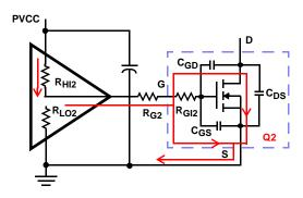
FIGURE 4. TYPICAL LOWER-GATE DRIVE TURN-ON PATH
