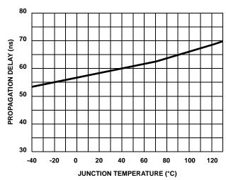
FIGURE 13. UPPER DISABLE TURN-OFF PROPAGATION DELAY t<sub>DISHIGH</sub> vs TEMPERATURE
