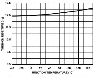
FIGURE 23. GATE DRIVE RISE TIME  $t_{\mbox{\scriptsize R}}$  vs TEMPERATURE
