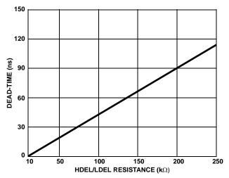
FIGURE 32. MINIMUM DEAD-TIME vs DEL RESISTANCE
