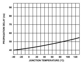
FIGURE 21. LOWER TURN-ON PROPAGATION DELAY t<sub>LPLH</sub> vs TEMPERATURE
