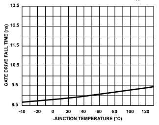
FIGURE 22. GATE DRIVE FALL TIME t<sub>F</sub> vs TEMPERATURE
