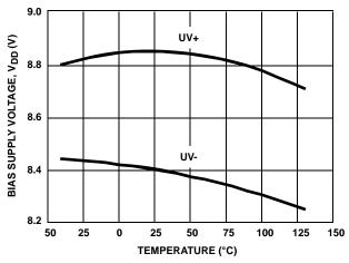
FIGURE 31. UNDERVOLTAGE LOCKOUT vs TEMPERATURE
