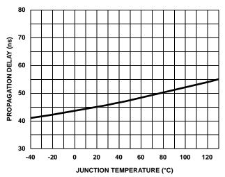
FIGURE 15. LOWER DISABLE TURN-OFF PROPAGATION DELAY t<sub>DISLOW</sub> vs TEMPERATURE
