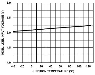
FIGURE 24. V<sub>LDEL</sub>, V<sub>HDEL</sub> VOLTAGE vs TEMPERATURE
