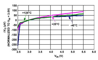
FIGURE 5. LINE REGULATION OVER TEMPERATURE
