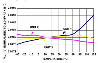
FIGURE 20. V<sub>OUT</sub> vs TEMPERATURE (3 UNITS)
