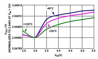
FIGURE 18. LINE REGULATION OVER TEMPERATURE
