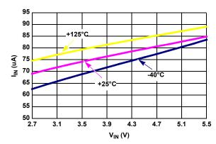
FIGURE 16.  $I_{IN}$  vs  $V_{IN}$  OVER TEMPERATURE
