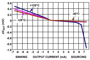
FIGURE 33. LOAD REGULATION OVER TEMPERATURE
