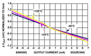
FIGURE 19. LOAD REGULATION OVER TEMPERATURE
