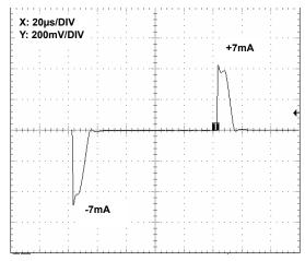
FIGURE 27. LOAD TRANSIENT RESPONSE, 0.001µF LOAD CAPACITANCE
