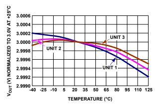
FIGURE 47. V<sub>OUT</sub> vs TEMPERATURE (3 UNITS)
