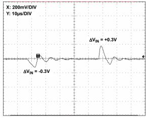
FIGURE 23. LINE TRANSIENT RESPONSE, 0.001µF LOAD CAPACITANCE
