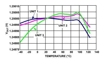
FIGURE 7. V<sub>OUT</sub> vs TEMPERATURE (3 UNITS)
