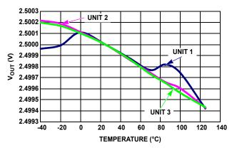
FIGURE 34. V<sub>OUT</sub> vs TEMPERATURE (3 UNITS)
