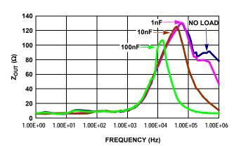
FIGURE 52. Z<sub>OUT</sub> vs FREQUENCY
