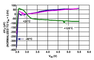
FIGURE 32. LINE REGULATION OVER TEMPERATURE
