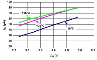
FIGURE 30.  $I_{IN}$  vs  $V_{IN}$  OVER TEMPERATURE
