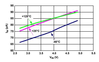
FIGURE 3.  $I_{IN}$  vs  $V_{IN}$  OVER TEMPERATURE
