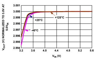
FIGURE 45. LINE REGULATION OVER TEMPERATURE
