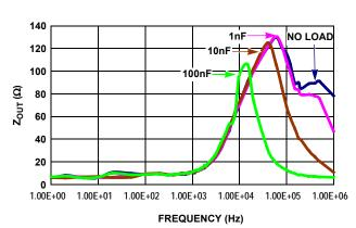
FIGURE 39. Z<sub>OUT</sub> vs FREQUENCY
