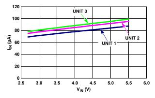
FIGURE 2. I<sub>IN</sub> vs V<sub>IN</sub> (3 UNITS)
